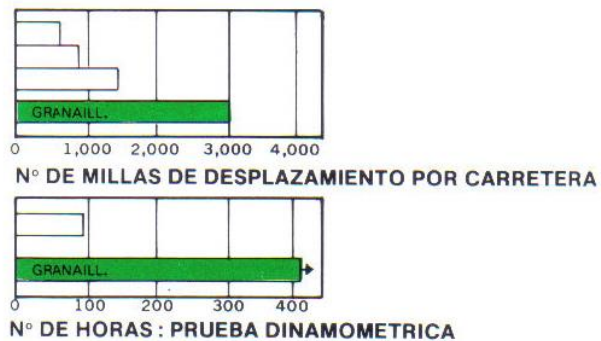
Fig. 31. INFLUENCIA DEL SHOT PEENING DESPUES DE LA ROTURA EN FATIGA DE PALAS DE VENTILADOR SOLDADAS
